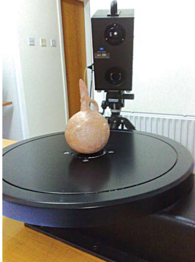
Διακρίνεται ο τρισδιάστατος σαρωτής, ο περιστρεφόμενος δίσκος και το υπό μελέτη αντικείμενο
