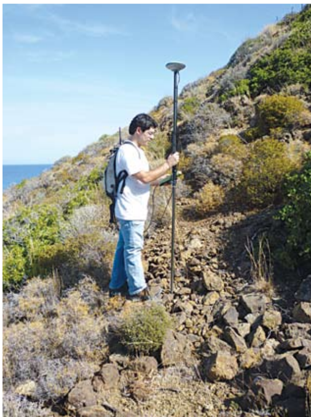
Τοποθέτηση σταθερών σημείων και προετοιμασία τοπογραφικής αποτύπωσης
