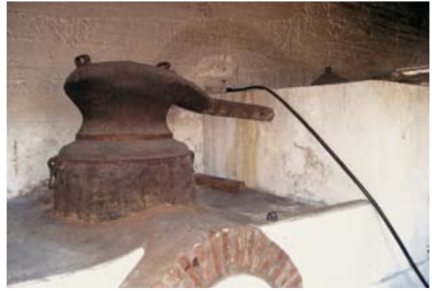
Καζάνι (αποστακτήρας). Ο παλιός τρόπος βρασμού λιωμένων σταφυλιών (τα ζίβανα) προκειμένου να γίνει η απόσταξη της ζιβανίας
