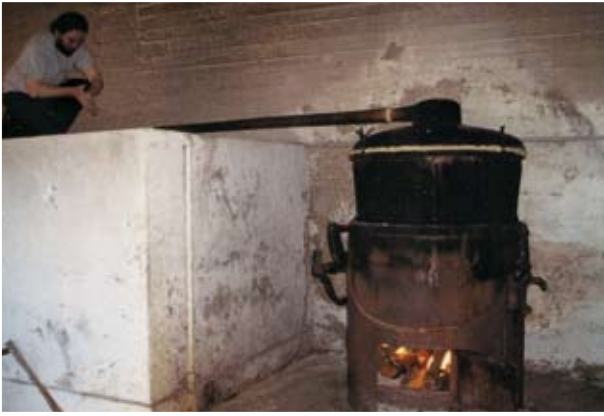
Καζάνι (αποστακτήρας). Ο παλιός τρόπος βρασμού λιωμένων σταφυλιών (τα ζίβανα) προκειμένου να γίνει η απόσταξη της ζιβανίας
